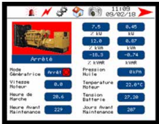
Page de SUPERVISION/CONTRÔLE par défaut
